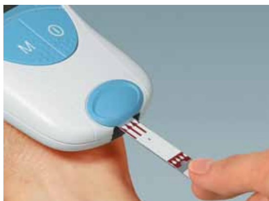
Figur 1. En teststrimmel indsættes i måleapparatet ...
